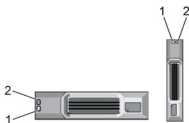
図 5. SCv300 および SCv320 拡張エンクロージャドライブインジケータ
